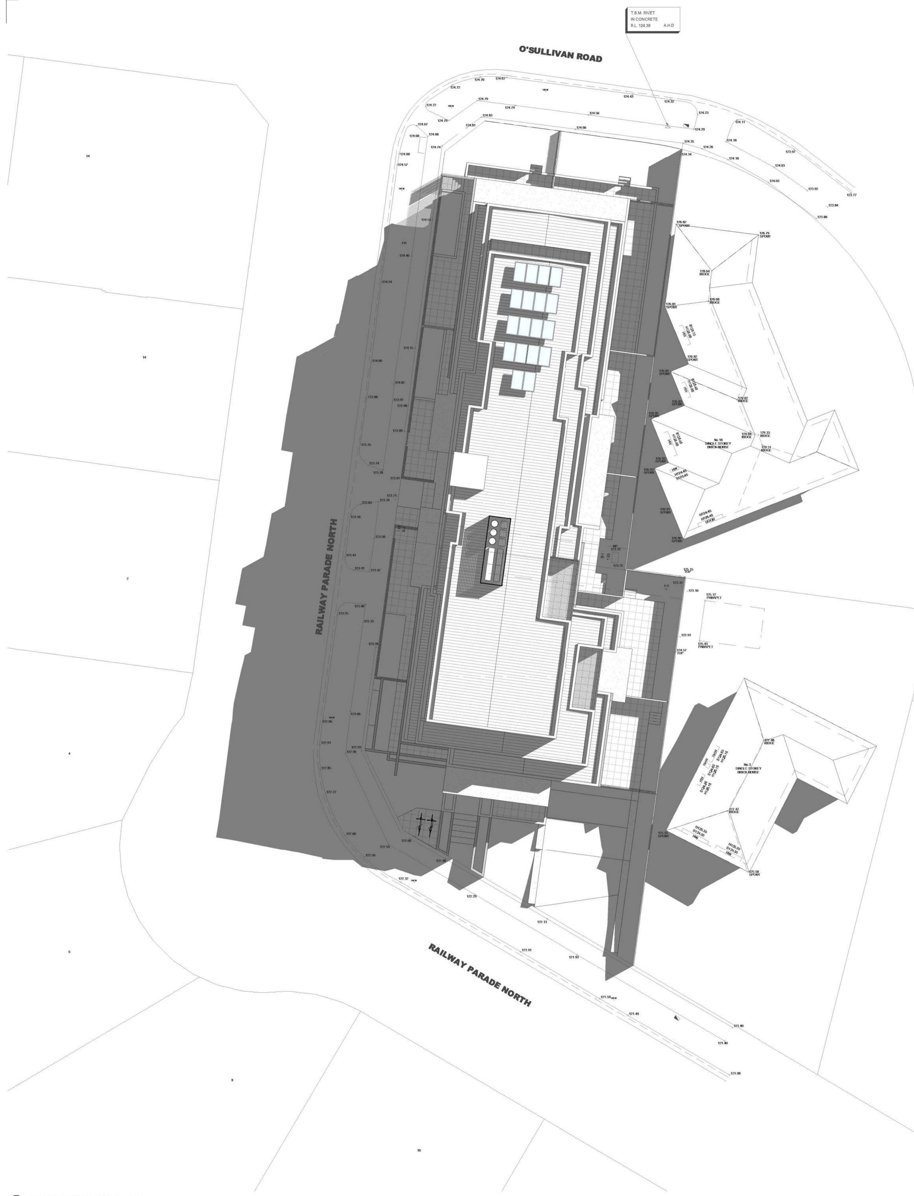
SHADOW DIAGRAM - SEP 22nd 9AM SCALE 1:200
